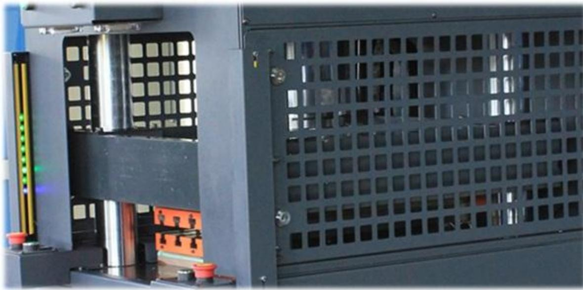
Возможные несчастные случаи на производстве предупреждаются с помощью светового барьера на наших прессах.
